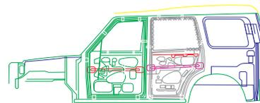
Barras en las puertas delanteras y traseras que proporcionan protección contra impactos laterales en caso de colisión.
